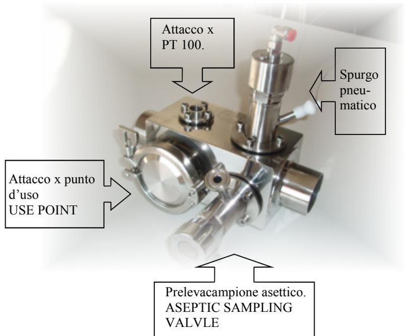
Esempio con corpo valvola tipo lungo: 4 STRUMENTI APPLICATI E 4 ALLOCAZIONI ANCORA DISPONIBILI.
